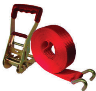
Sangle extérieure 9M6T. Crochets bord de rive. LC : 2000 dAN.
