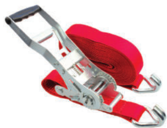
Sangle extérieure 9M7T5. Cliquet inversé. Crochet serrés. LC : 2500 dAN.
